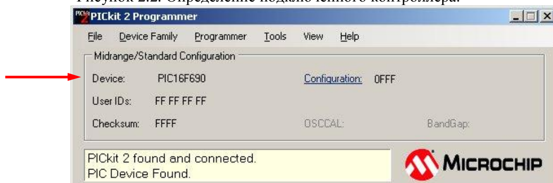
Рисунок 2.2. Определение подключенного контроллера.
