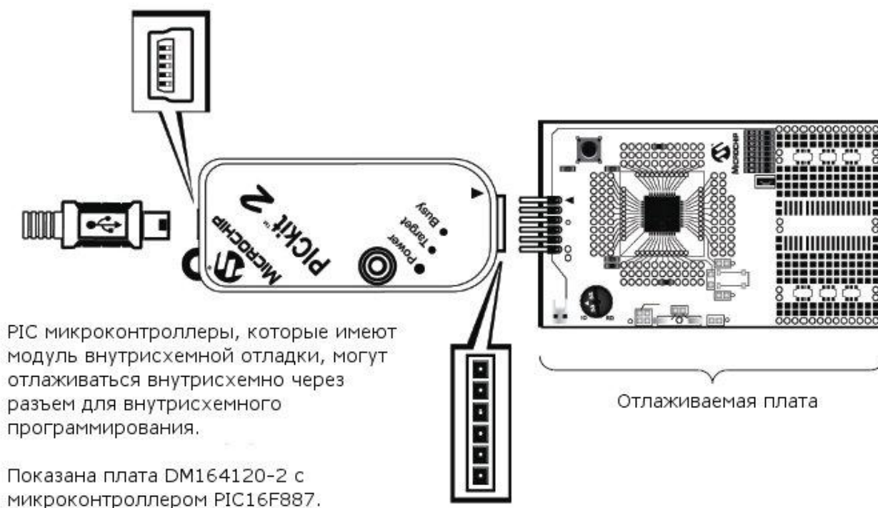
Рис.4-2. Подключение PICkit2 к отладочной плате.
